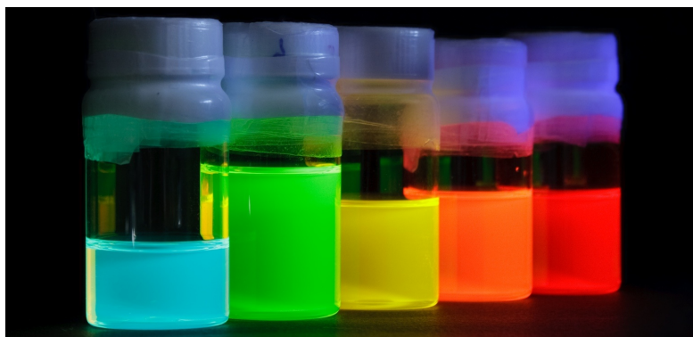
Figuur 1 – Luminescerende CdSe quantum dots met afmetingen tussen 1.5 en 6 nm
